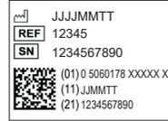
Beispiel für eine UDI-Kennzeichnung (befindet sich auf der Rückseite des Aggregates und in der Naht des Matratzenbezugs/der Bodenwanne).
