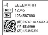
Παράδειγμα ετικέτας UDI (βρίσκεται στο πίσω μέρος της μονάδας ισχύος και στη ραφή του καλύμματος του στρώματος/ του δίσκου βάσης)
