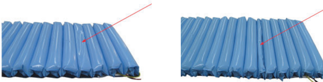
Eksempler på punkterede øvre celler.
