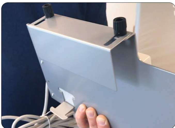
Løsn skruerne på ophængspladen til kontrolenheden
