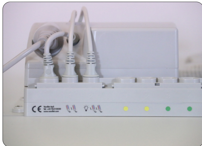
Håndbetjeningen tilsluttes kontrolenheden
