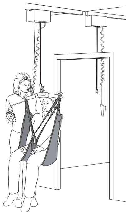
Dès que la sangle de levage du moteur de levage 1 est suffisamment soulagée, la décrocher du crochet RTH.
