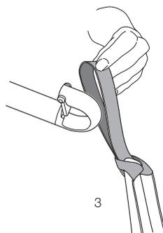
1. Annodare l'anello AdjustmentLoop attorno all'anello dell'imbracatura.
