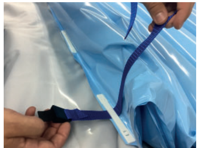
4. Om de band vast te zetten, voert u hem door de eerste celbevestigingsadapter.
