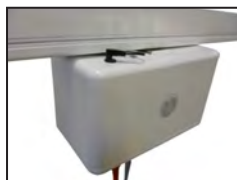
Bild 5; Kablet fra løbekatten kobles ind
