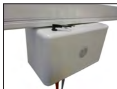
Bilde 5; Kabelen fra kjørevognen kobles inn
