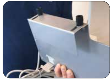
Løsn skruerne på ophængspladen til kontrolenheden
