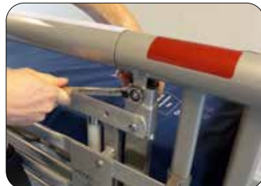
Monter igen møtrik og bolt
