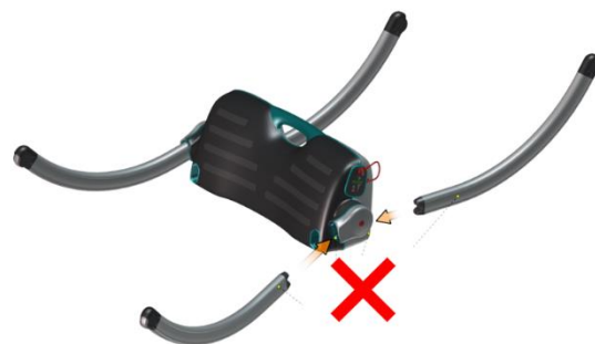
Felaktig montering (benen får INTE monteras först)
